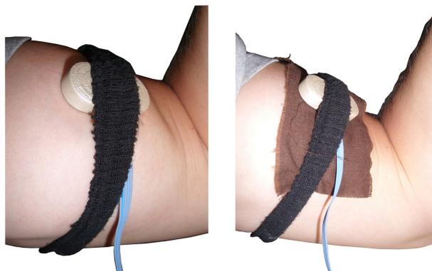
**Abbildung 5.10.:** Anbringung der kapazitiven Elektroden am Bizeps
