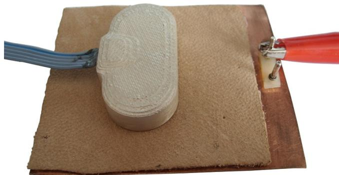
**Abbildung 5.2.:** Einfache Haut-Muskel-Simulationseinrichtung
