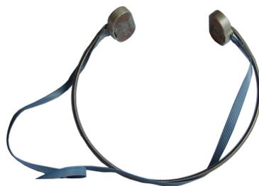
**Abbildung 5.12.:** Befestigungskonzept 1: Bügelbefestigung
