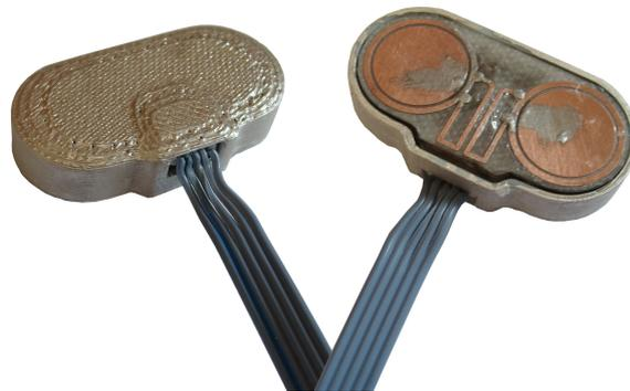
Abbildung 4.4.: Entwickeltes kapazitives Sensorelement
