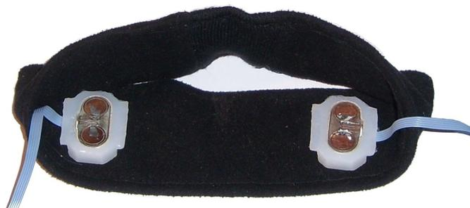
**Abbildung 5.15.:** Befestigungskonzept 2: Halskrause mit Elektroden
