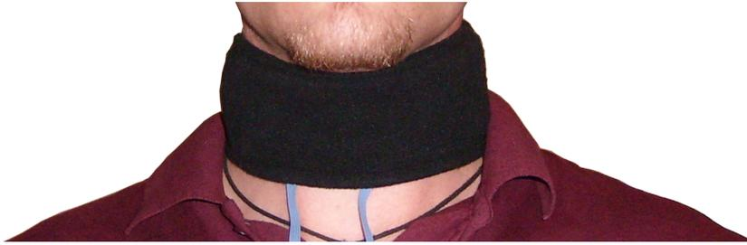
Abbildung 5.16.: Befestigungskonzept 2: Halskrause in der Anwendung
