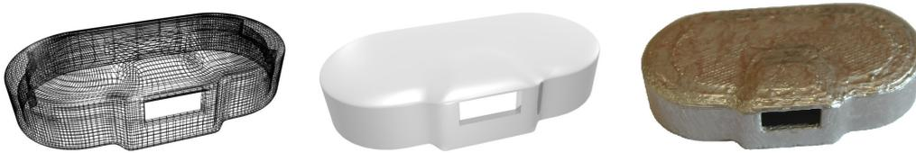
**Abbildung 4.7.:** Gehäuse der Elektrode: Drahtgittermodell (links), Solid-Modell (mitte), geplottet und mit Silberfarbe bemalt (rechts)
